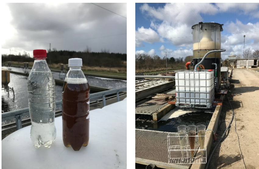
Fig. 12. Vandprøven ovenfor t.v. er fra anlægget, flasken til højre indeholder en vandprøve fra palletanken der indeholder vandigt skum / rejekt vand fra skimmeren (9. april, 2021).
