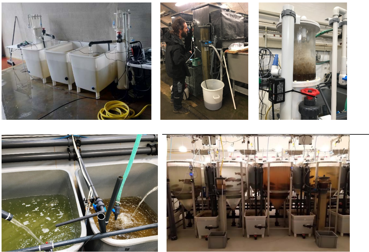
Fig. 4. Eksempler på forsøgsopstillinger med test af rensning af dambrugsvand ved hjælp af proteinskimning og ozon.
