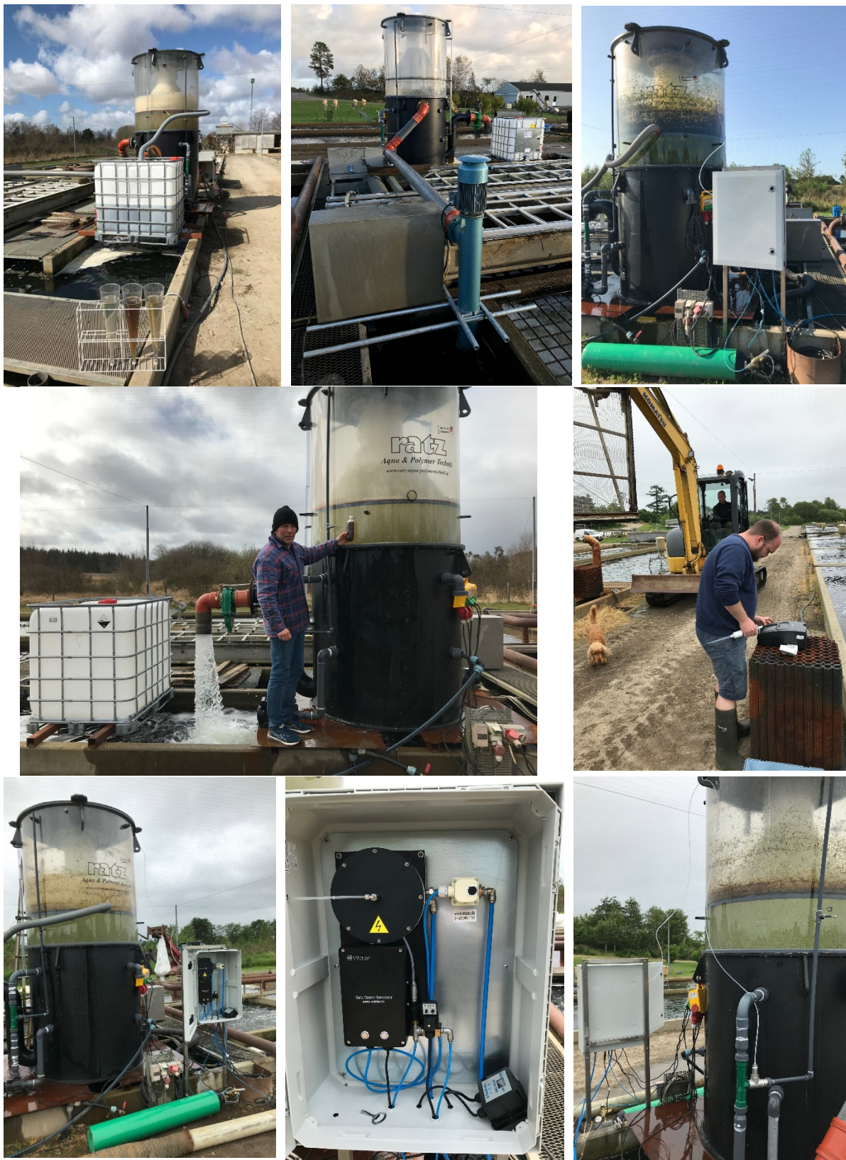
Fig. 5. Test of afprøvning af proteinskimmer på et model 3 dambrug. Skummet i toppen af skimmeren ledes over i en palletank hvorved volumen og koncentration kan bestemmes. De nederste billeder viser kabinnet med ozon generator hvor den dannede ozon ledes via en venturi ventil ind i skimmeren.
